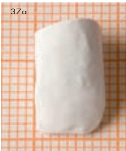
Abb. 37a Der überdimensionierte Grünling aus Zirkonoxid (Lava, 3M Espe) in gefrästem und ungesintertem Zustand ... Abb. 37b ... und das fertig gesinterte Kronengerüst
